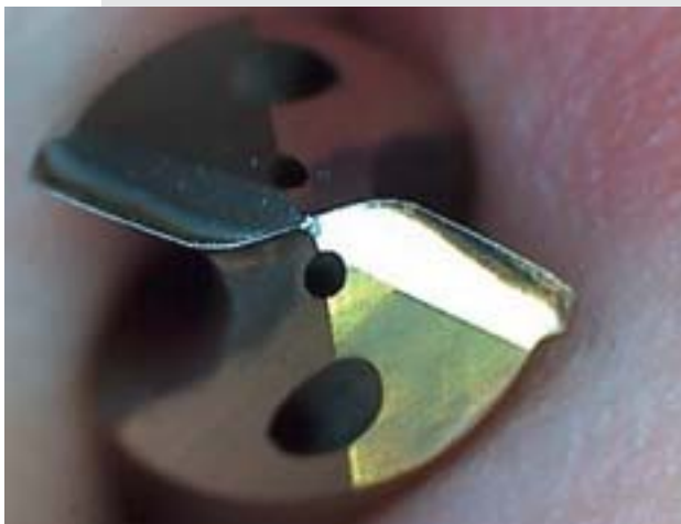
WEXO XS5D KTAZ-HM nach ca. 1280 Bohrungen · after 1280 holes
